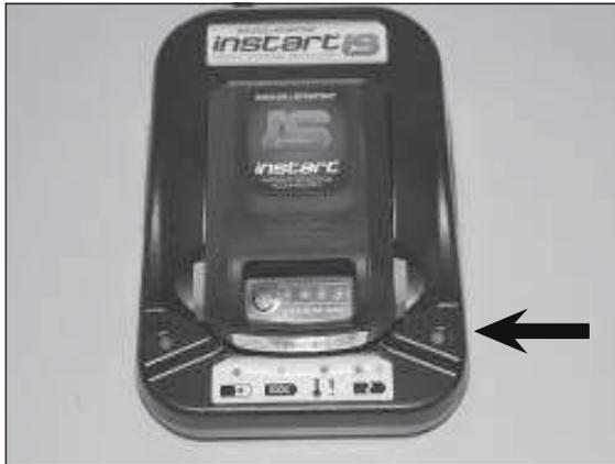
Ist die Batterie vollständig geladen, schaltet das Ladegerät automatisch ab. Die rote Leuchtdiode erlischt und rechts leuchtet die grüne Leuchtdiode auf. Die Batterie nach Ladeende aus dem Ladegerät entfernen.
