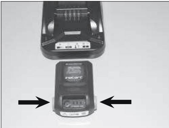
Beide Sperrhebel gleichzeitig drücken und die Batterie in das Ladegerät bis zum ersten spürbaren Widerstand schieben - dann bis zum Anschlag drücken.
