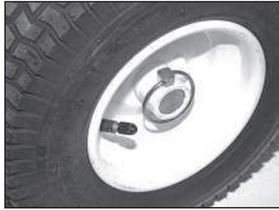
2) Wendefreilauf ausschalten: Klappsplint durch Achse und Nabe stecken (z.B. beim Kehren auf schrägen Flächen)
