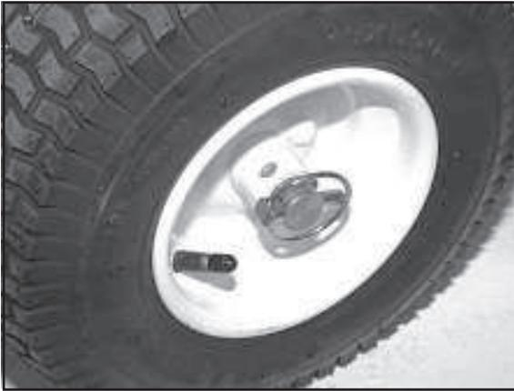
1. Wendefreilauf einschalten: Klappsplint nur durch die Achse stecken.
