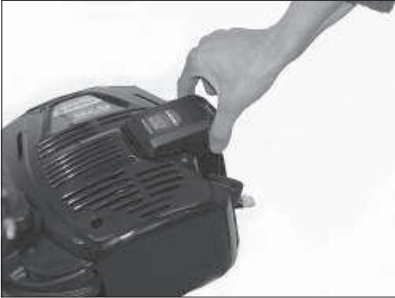
Beide Sperrhebel gleichzeitig drücken und die Batterie aus dem Gehäuse herausnehmen.
