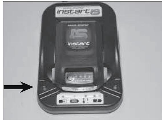
Nach dem Einsetzen der Batterie leuchtet die rote Leuchtdiode links am Ladegerät und der Ladevorgang beginnt.
