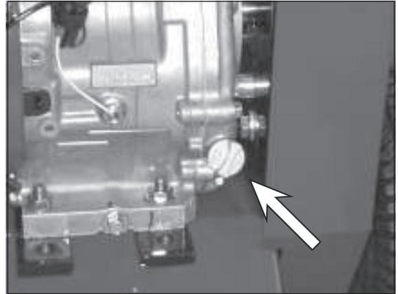
Öleinfüllverschluss beim Honda Motor.
