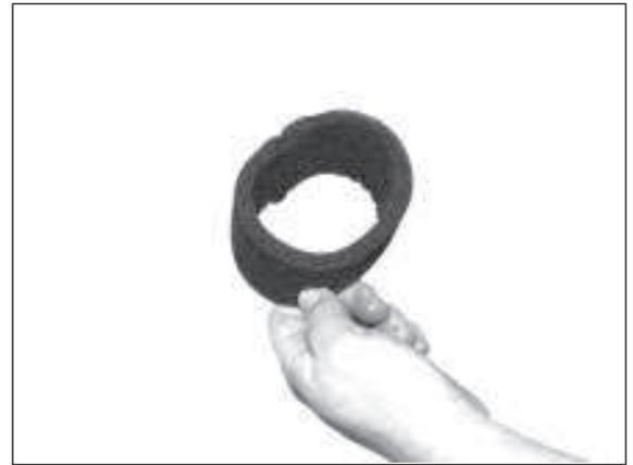
10) Grobfilter vorsichtig ausklopfen oder mit Pressluft reinigen.
