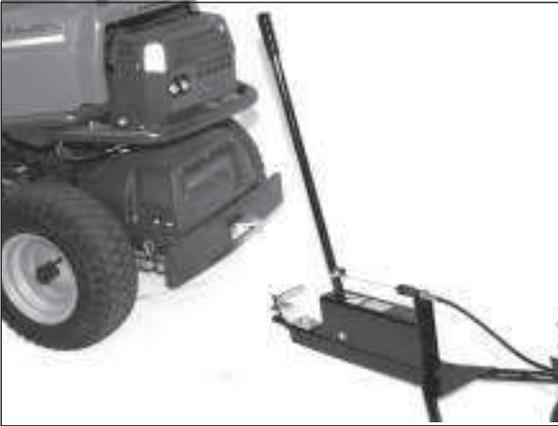
1) Deichsel des Vertikutierers zur Anhängerkupplung der Zugmaschine ziehen.
