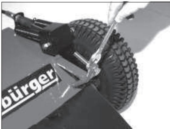
3) Lösen Sie zunächst die Kontermutter.
