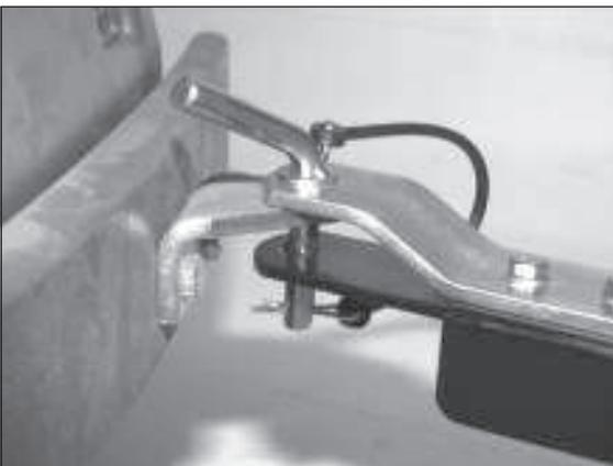
5) Vergewissern Sie sich, dass der Vertikutierer sicher mit der Zugmaschine verbunden ist.
