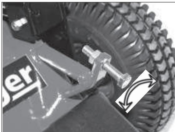
4) Drehen im Uhrzeigersinn (+) : Messer anheben
