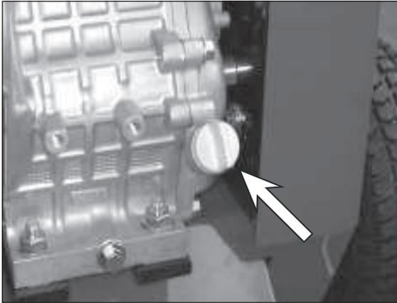
Öleinfüllverschluss beim B&S-Motor.
