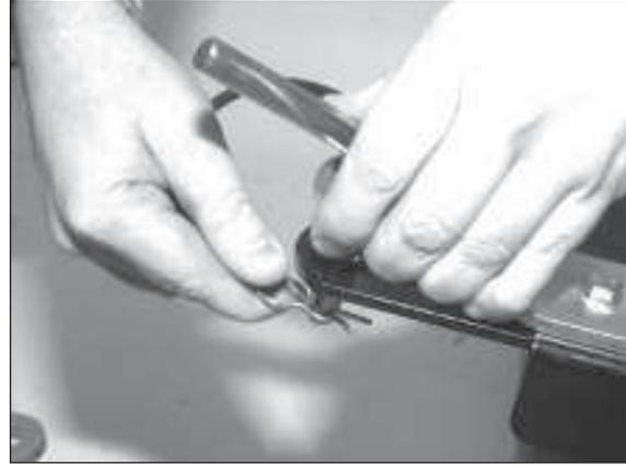
2) Federstecker entfernen und Bolzen durchstecken.
