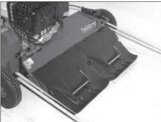
3) Transport mit einem Kraftfahrzeug: Befestigen Sie das Gerät mit Spannriemen. Deichsel und Hinterachse dienen als Befestigungspunkte.
