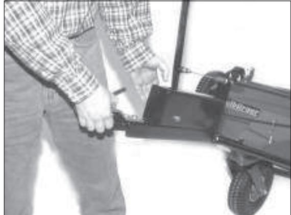
2) Fassen Sie niemals an den Schalthebel, sondern an die Deichsel oder an die Schaltkonsole.
