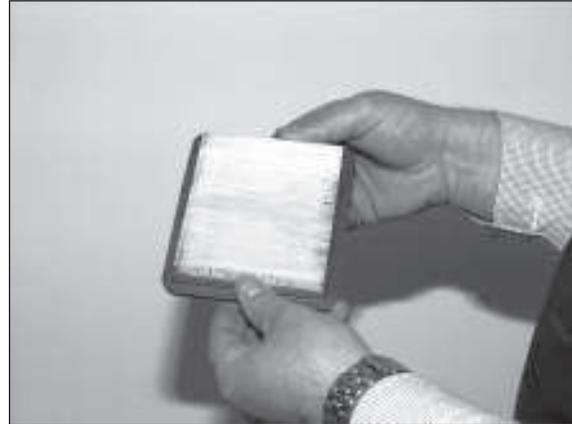
4) Lamellen vorsichtig ausklopfen oder mit Pressluft reinigen.
