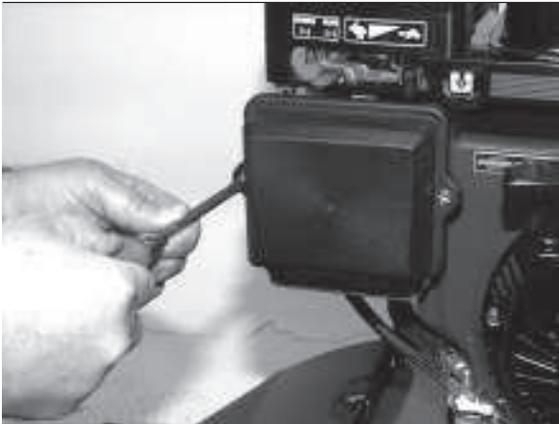
1) Schrauben des Luftfilterdeckels lösen.
