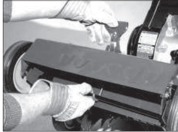
4) Nun die Verriegelung nach unten drücken.
