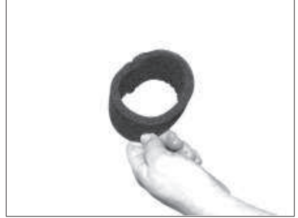
6) Grobfilter vorsichtig ausklopfen oder mit Pressluft reinigen.
