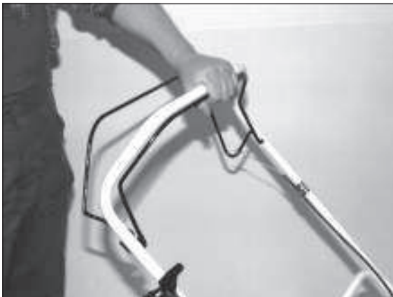
1) Durch Ziehen des Sicherungsbügels und anschließendem drücken des Schaltbügels wird der Messerantrieb eingeschaltet.
