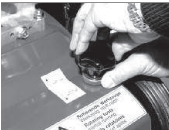
5) Kontermutter wieder festdrehen, Einstellschraube dabei festhalten.
