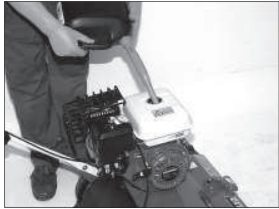
2) Halten Sie den Kanister wie auf dem Bild. Füllen Sie nur jeweils eine geringe Menge ein und kontrollieren Sie die Füllhöhe.
