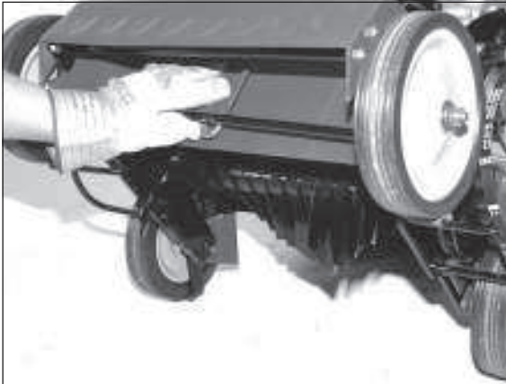
3) Vertikutierereinheit anheben und in den Haken hängen.
