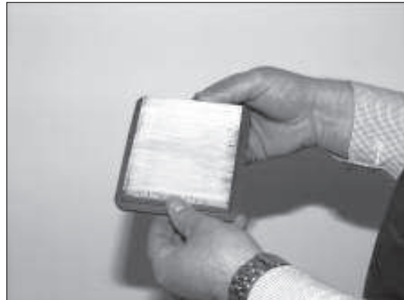
4) Lamellen vorsichtig ausklopfen oder mit Pressluft reinigen.
