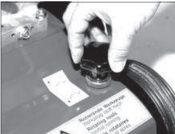
3) Beim Drehen der Einstellschraube wird die Vertikutiertiefe eingestellt.
