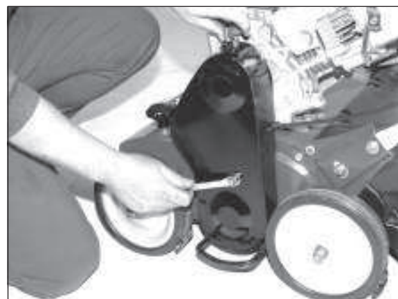
8) Abschließend den Keilriemenschutz aufsetzen und festschrauben.
