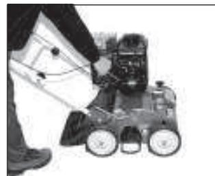
4) Ziehen am Starterseil. Achten Sie darauf, dass Sie hinter dem Lenker und außerhalb der Gefahrenzone stehen.
