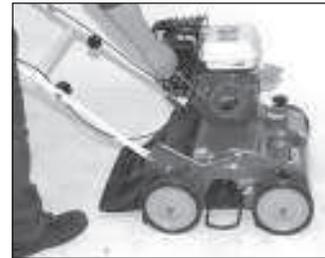
4) Ziehen am Starterseil. Achten Sie darauf, dass Sie hinter dem Lenker und außerhalb der Gefahrenzone stehen.
