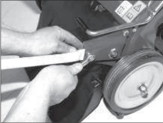
1) Über ein Langloch in der Gehäusewand ist die Lenkerhöhe einstellbar. Lösen Sie die Schrauben der Lenkerverbindung. Verfahren Sie mit der gegenüberliegenden Seite ebenso.
