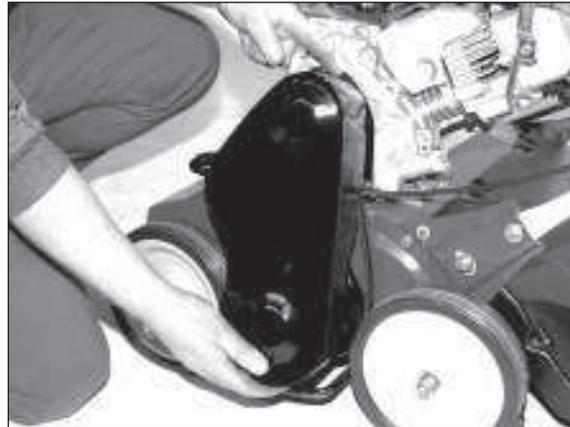
2) Entfernen Sie den Keilriemenschutz.
