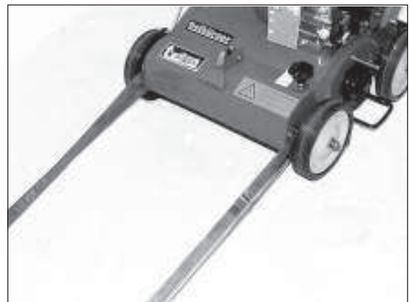
4) Vorder- und Hinterachse dienen als Befestigungspunkte. Führung des Spannriemens vorne.
