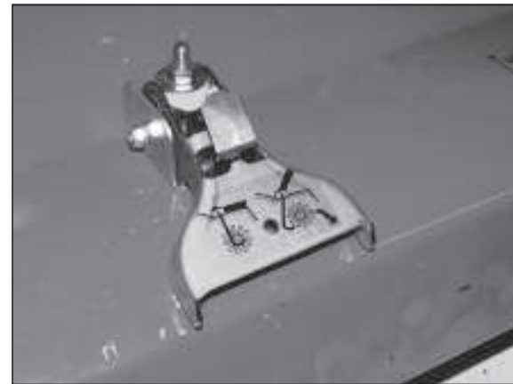
6) Vertikutierereinheit ist verriegelt.
