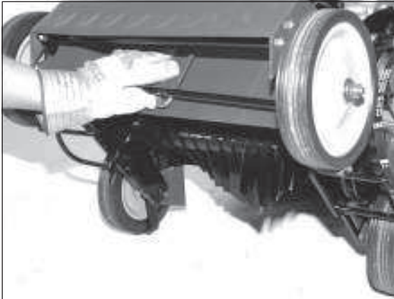
3) Vertikutierereinheit anheben und in den Haken hängen.
