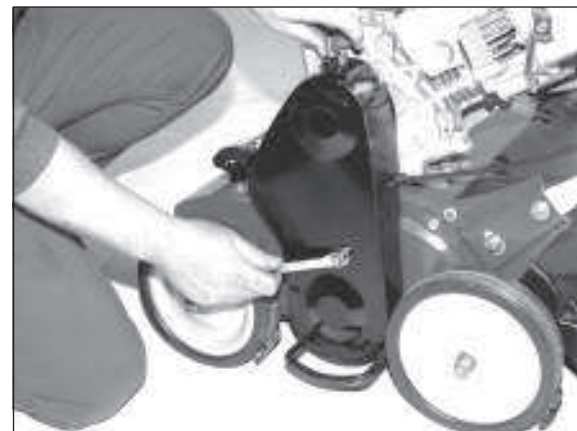
8) Abschließend den Keilriemenschutz aufsetzen und festschrauben.
