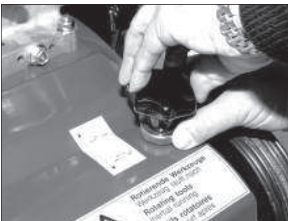
5) Kontermutter wieder festdrehen, Einstellschraube dabei festhalten.
