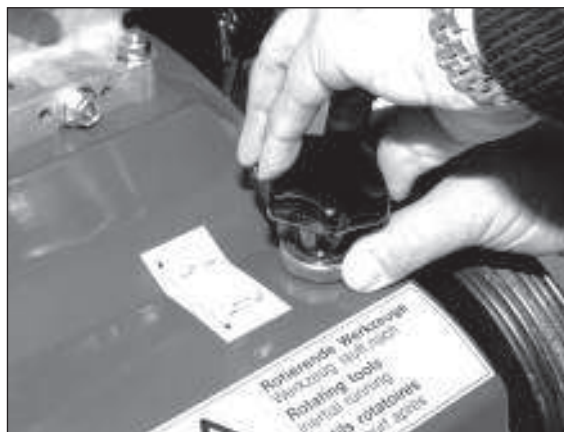
2) Lösen Sie zunächst die Kontermutter.
