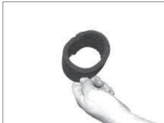
5) Grobfilter vorsichtig ausklopfen oder mit Pressluft reinigen.
