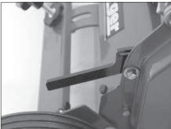
Kurz auf den Lenker drücken, so dass der Vertikutierer angehoben wird
