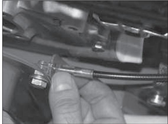
2) Sechskantmutter lösen, Bowdenzug einstellen und Sechskantmutter wieder anziehen.
