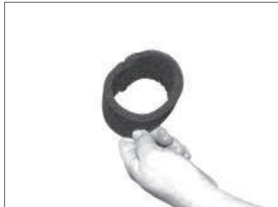
6) Grobfilter vorsichtig ausklopfen oder mit Pressluft reinigen.
