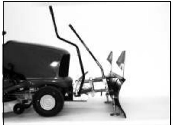
6) Heben Sie das Räumschild an und entfernen Sie die Holzstücke. Der Abstand zwischen Boden und Gummileiste sollte 2-3 mm betragen.
