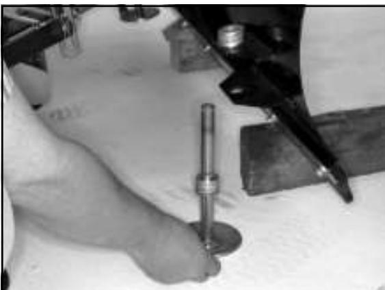
5) Nach der Höhenverstellung wird die Kufe durch die Führungen nach oben geschoben und mit dem Klappsplint gesichert. Links ebenso verfahren.
