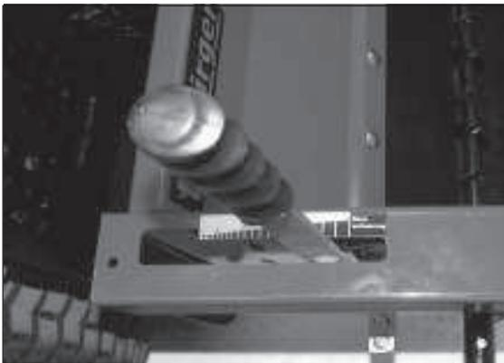
1) Bedienhebel in das Stellsegment der Streumengen-Regulierung einrasten.
