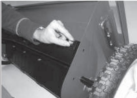
1) Deichsel des Kastenstreuers zur Anhängerkupplung der Zugmaschine ziehen.
