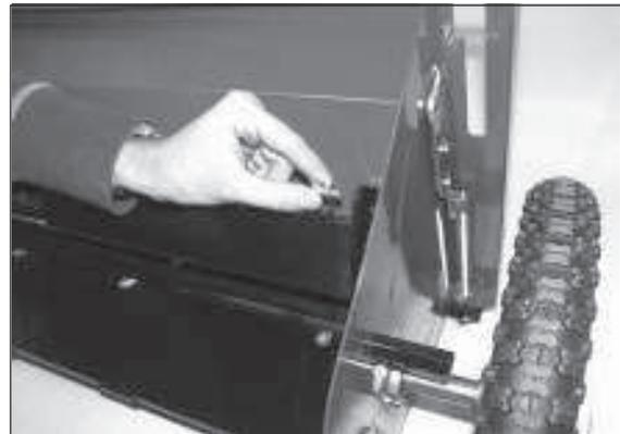
2) Kupplung der Zugmaschine und die des Kastenstreuers in Deckungsgleichheit bringen und Bolzen durchstecken.
