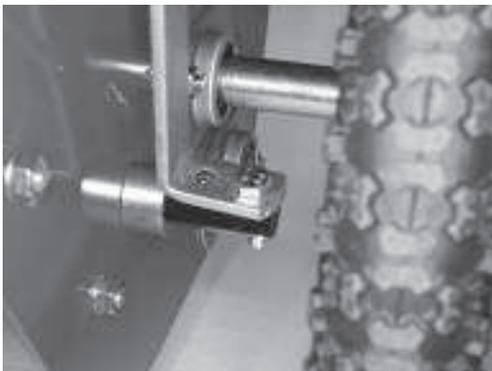
Schrauben durch die Bohrungen des Hebels und der Sechskantwelle schieben. Mit Scheiben und Muttern montieren.
