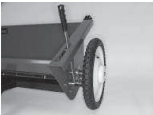
Alle Schraubverbindungen fest anziehen. Korrekt montierter Bedienhebel.
