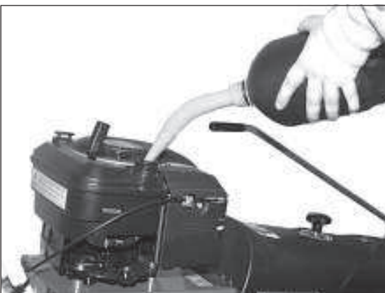
3) Halten Sie den Kanister wie auf dem Bild. Füllen Sie nur jeweils eine geringe Menge ein und kontrollieren Sie die Füllhöhe.
