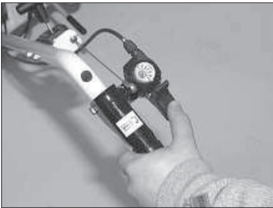
1) Tiptaste niederdrücken = Kehrbürste dreht schneller.
