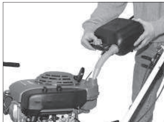
4) Halten Sie den Kanister wie auf dem Bild. Füllen Sie nur jeweils eine geringe Menge ein und kontrollieren Sie die Füllhöhe.
