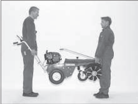
1) Anheben der Maschine.
