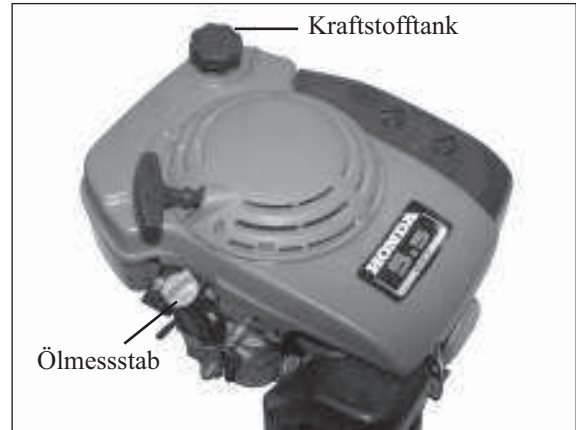
1) Kraftstoff- und Öltank beim Honda-Motor
