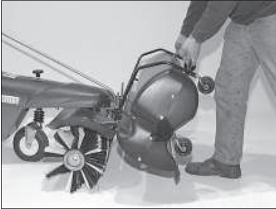
6) Um den Kehrgutbehälter zu entleeren, einfach den vorderen Bügel greifen und den Kehrgutbehälter hochschwenken.
