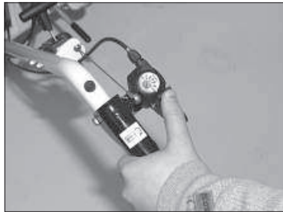
2) Tiptaste nach vorne drücken = Kehrbürste dreht langsamer.
