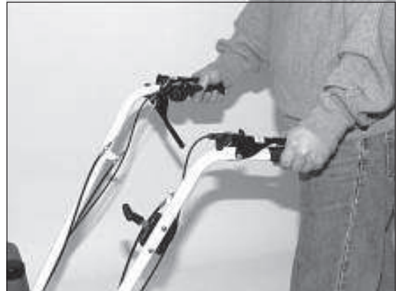
4) Durch Betätigen beider Schalthebel werden sowohl Kkehrbürsten- als auch Fahrtrieb eingeschaltet.
