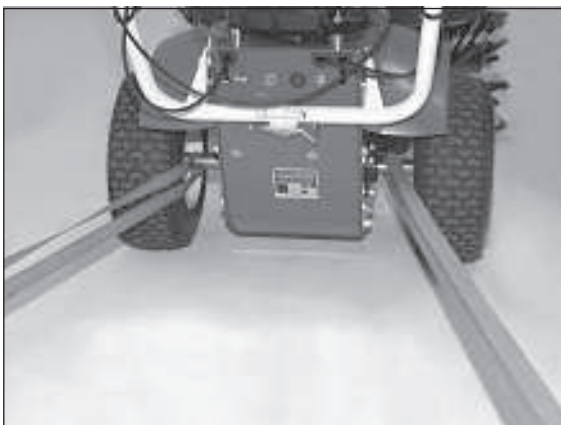
5) Verwenden Sie auf jeden Fall beide Befestigungspunkte.
