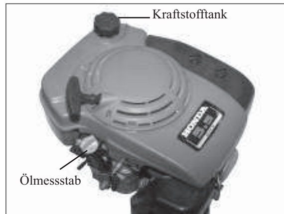
2) Kraftstoff- und Öltank beim Honda-Motor
