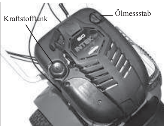
1) Kraftstoff- und Öltank beim B&S-Motor
