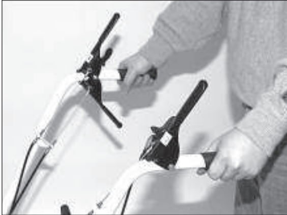
1) Am Lenker befinden sich die Schalthebel für den Fahr- und Kkehrbürstenantrieb.
