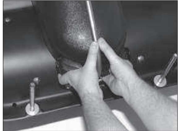
2) Haltepunkte vorne für das Anheben der Maschine.
