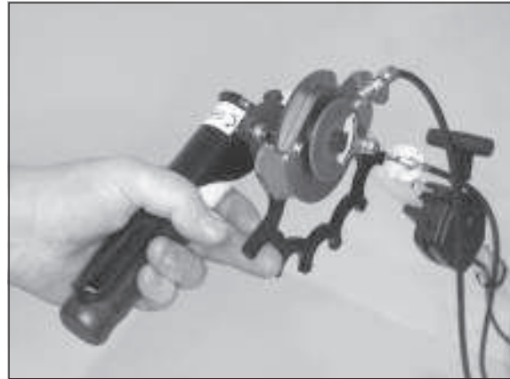
2) Tipptaste nach oben drücken = Kehrbürste dreht langsamer
