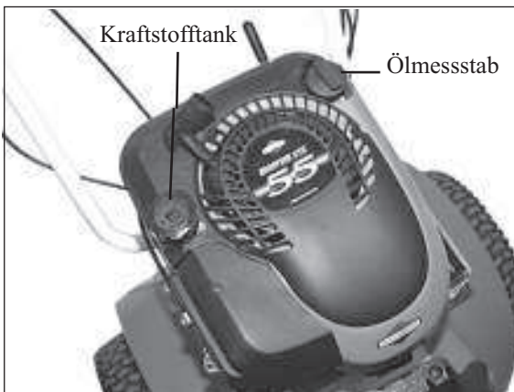
1) Kraftstoff- und Öltank beim B&S-Motor
