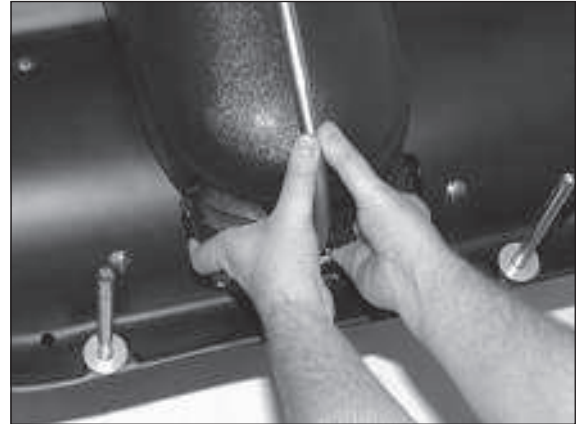
2) Haltepunkte vorne für das Anheben der Maschine.
