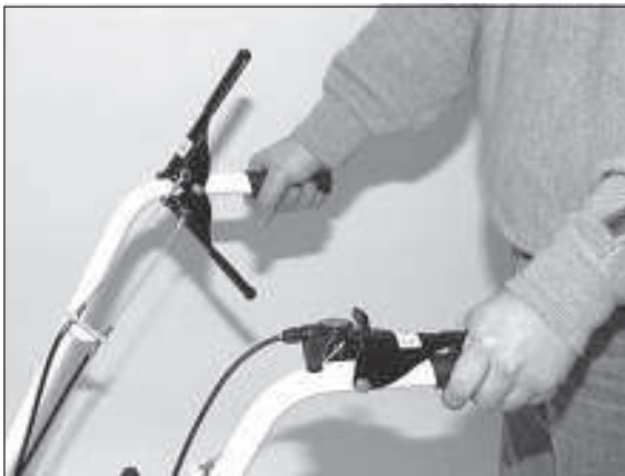
3) Mit der linken Hand wird die Kehrbürste eingeschaltet.
