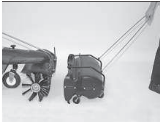
2) Zum Umfüllen des Kehrguts in ein anderes Behältnis (z.B. Schiebkarre), den Kehrgutbehälter komplett abnehmen.
