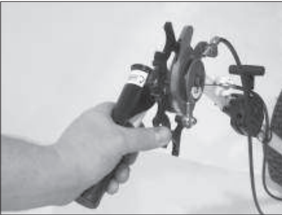
1) Tipptaste niederdrücken = Kehrbürste dreht schneller
