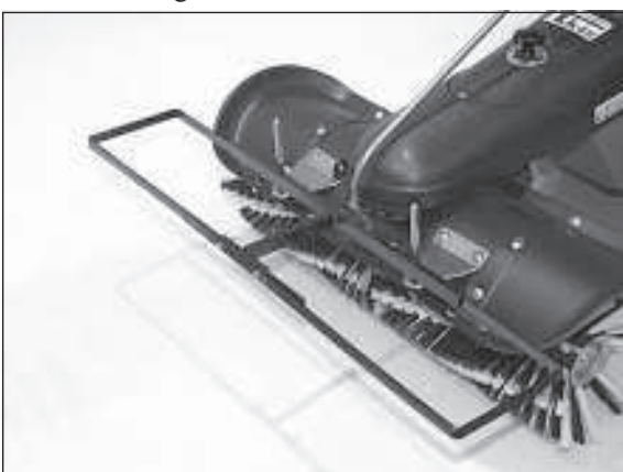
1) Den montierten Rahmen auf die Aufnahmestangen stecken.
