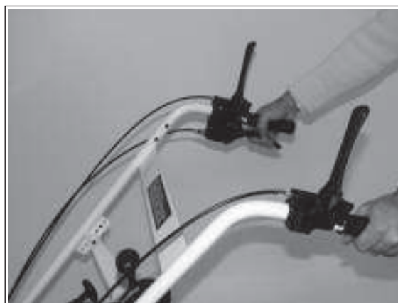
2) Solange Sie den Schalthebel drücken, fährt die Maschine rückwärts.
