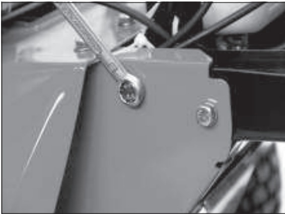
1) Schrauben entfernen, werden wiederverwendet.
