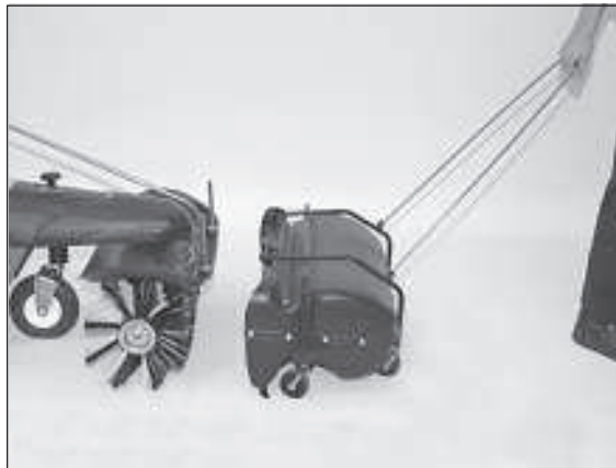
2) Zum Umfüllen des Kehrgruts in ein anderes Behältnis (z.B. Schiebkarre), den Sammelbehälter komplett abnehmen.
