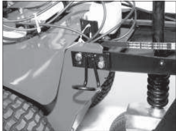
4) Korrekt montierte Zugöse. Auf der Gegenseite ebenso verfahren.
