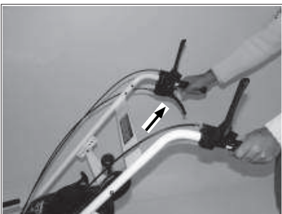
1) Der untere Schalthebel am rechten Griff schaltet den Rückwärtsgang ein.
