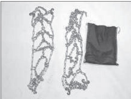
1) Zur besseren Kraftübertragung der Räder bei Schnee empfehlen sich Schneeketten.
