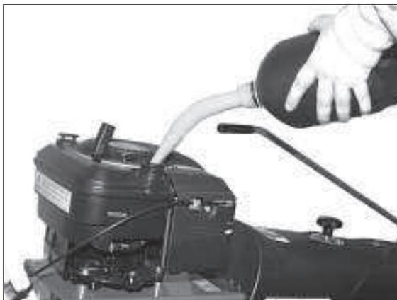
3) Halten Sie den Kanister wie auf dem Bild. Füllen Sie nur jeweils eine geringe Menge ein und kontrollieren Sie die Füllhöhe.
