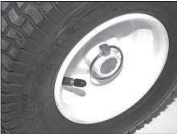
3) Wendefreilauf ausschalten: Klappsplint durch Achse und Nabe stecken (z.B. beim Kehren auf schrägen Flächen)
