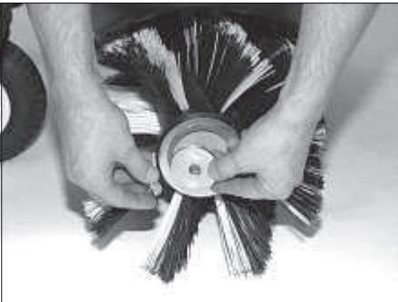
9) Nachdem die beiden Bürsten aufgesteckt sind, die Kappe und Unterlegscheibe auf die Achse schieben.
