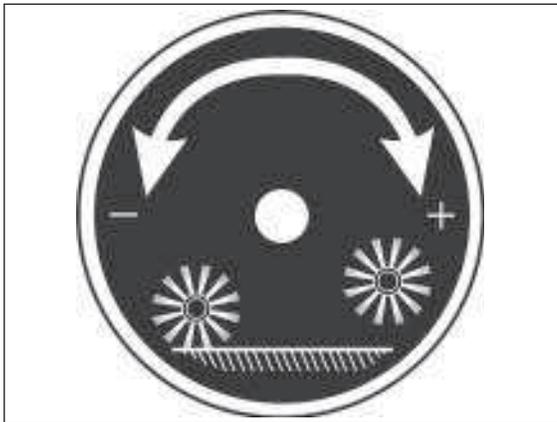
3) Drehen im Uhrzeigersinn (+) : Bürste anheben
