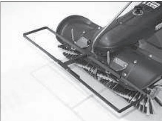
1) Den montierten Rahmen auf die Aufnahmestangen stecken.
