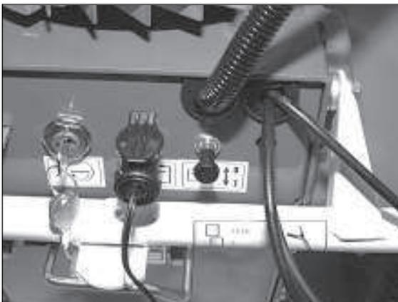
5) Bei entladener Batterie ca. 10-12 Stunden aufladen. Anschließend Ladegerät entfernen.
