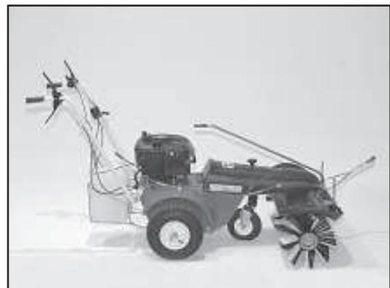
6) Einsatzbereite Kehrmaschine mit Wassersprüheinrichtung.
