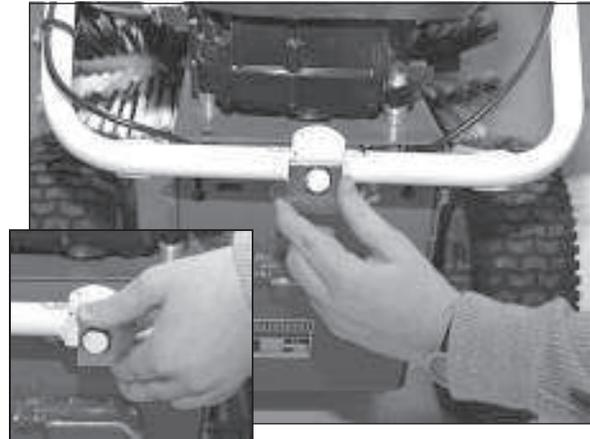
2) Den Lenker etwas nach vorne klappen und das Verstellelement drehen.
