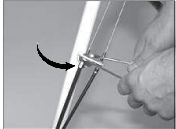
2) Anschließend die untere Mutter festdrehen.
