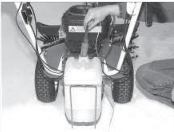
3) Der Wasser-Kanister in den Kanisterhalter stellen, mit Wasser füllen und die Wasserpumpe einsetzen.
