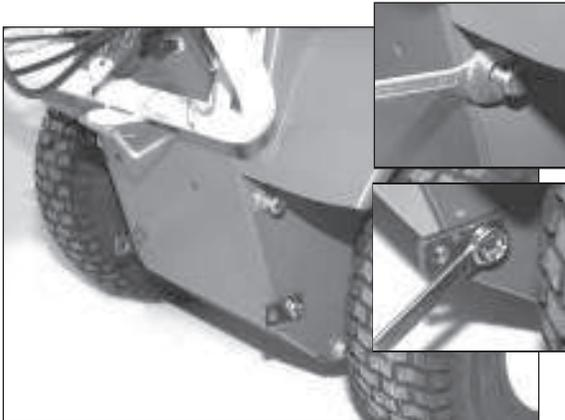
1) Für die Befestigung des Kanisterhalters müssen am Gehäuse einmalig Halterungen montiert werden.
