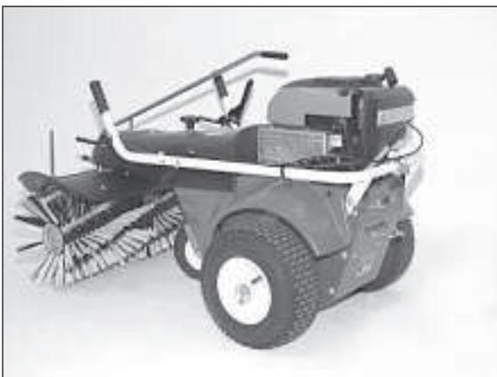
5) Zum Abstellen/Einlagern des Gerätes können Sie den Lenker ganz nach vorne klappen, um den Platzbedarf des Gerätes zu minimieren.
