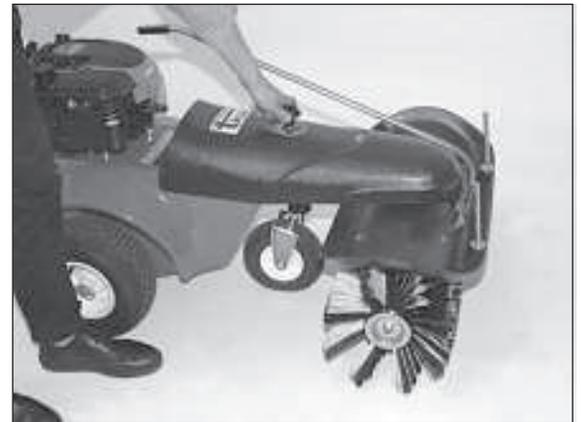
4) Senken Sie die Bürste so weit ab, dass sie gerade eben den Boden berührt. Dann noch 3 Umdrehungen entgegen dem Uhrzeigersinn in Pfeilrichtung (-) drehen.
