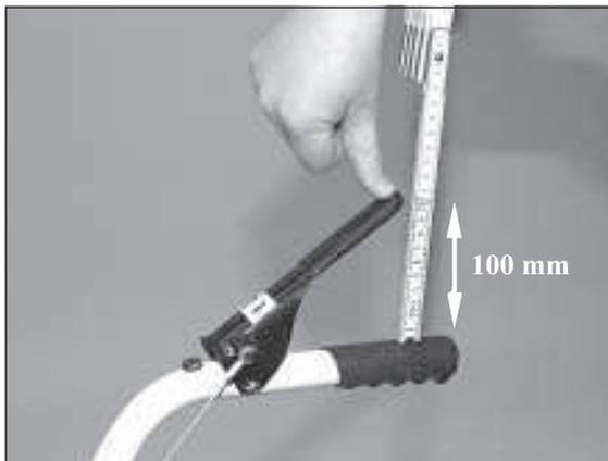
3) Überprüfen Sie die vorgenommene Einstellung, indem Sie den Hebel herunterdrücken. Nach einem Leerweg muss deutlich bei 100 mm ein Widerstand zu spüren sein. Wenn die Einstellung noch nicht korrekt ist, wiederholen Sie bitte die Schritte 1 und 2.
