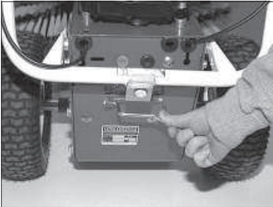
1) Der Lenker kann 4-fach in der Höhe verstellt werden. Den Entriegelungsbügel nach unten drücken.
