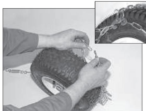
4) Die hinteren Kettenenden hochziehen und verhaken. Die vorderen Kettenenden über das Rad ziehen und verhaken.
