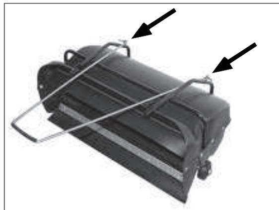
2) Zugbügel in die dafür vorgesehenen Ösen am Kehrgutbehälter stecken.
