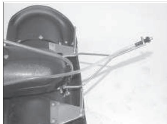
4) Den Düsenträger in die Bohrungen am Stellsegment einhängen.
