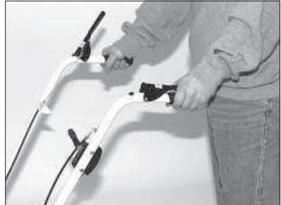
2) Mit der linken Hand wird die Kehrbürste eingeschaltet.
