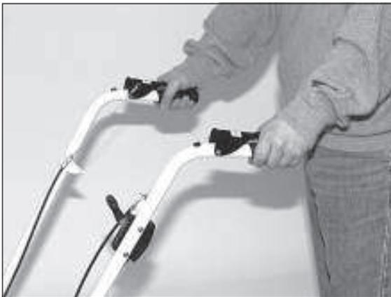
3) Durch Betätigen beider Schalthebel werden sowohl Kehrbürsten- als auch Fahrtrieb eingeschaltet.
