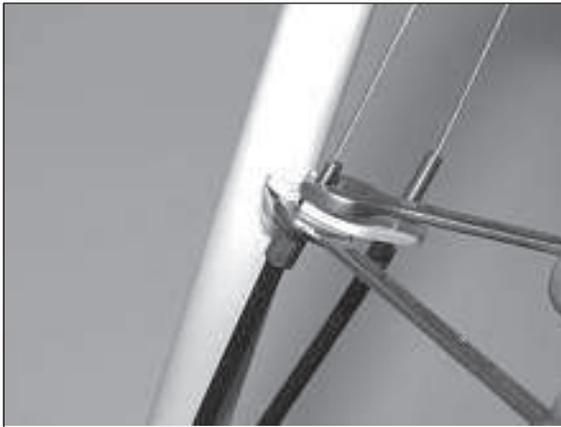
1) Die obere Mutter mit einem 10er-Maulschlüssel um ca. eine Umdrehung lösen.
