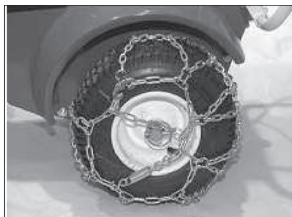
6) Das Rad mit montierter Schneekette auf die Achse stecken und anschließend mit dem Klappsplint sichern. Die zweite Kette auf die gleiche Weise montieren.
