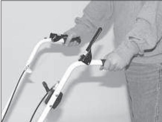
1) Durch Drücken des rechten Schalthebels schaltet man den Fahrtrieb ein.
