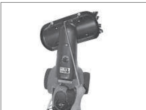
3) Das Kehrgrut wird nun seitlich abgelegt bzw. beiseite gekehrt. Diese Einstellung ist besonders für Schnee vorteilhaft, um Gehwege freizumachen. Hier: Wurfrichtung links.
