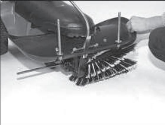
7) Bei der Montage der neuen Kkehrbürsten wird zuerst die rechte Kkehrbürste mit der Achse aufgesteckt. Beachten Sie hierbei den vorherigen Montagehinweis.
