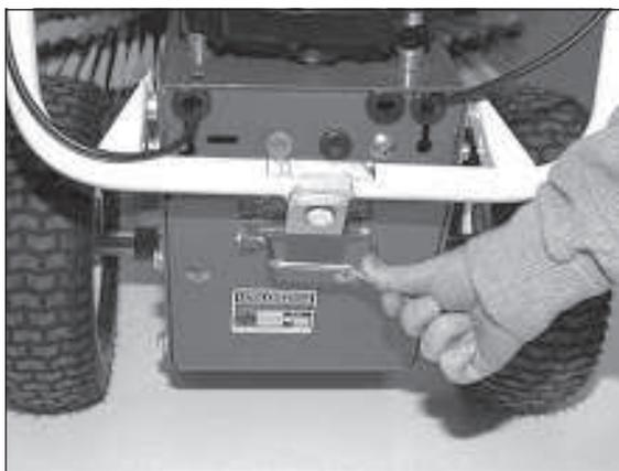
1) Der Lenker kann 4-fach in der Höhe verstellt werden. Den Entriegelungsbügel nach unten drücken.
