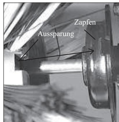
6) **Montagehinweis.** Die Ausparung an der Kkehrbürste wird an den Zapfen am Getriebe gesetzt.
