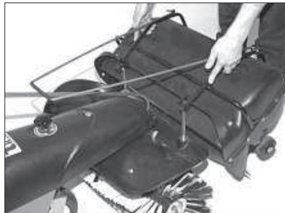
4) Kehrgutbehälter auf die Aufnahmestangen stecken.
