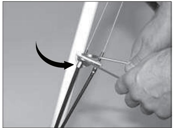
2) Anschließend die untere Mutter festdrehen.
