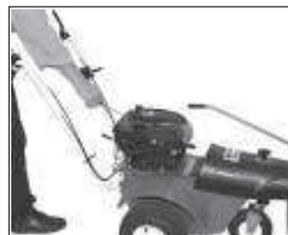
3) Ziehen am Starterseil. Achten Sie darauf, dass Sie hinter dem Lenker und außerhalb der Gefahrenzone stehen.
