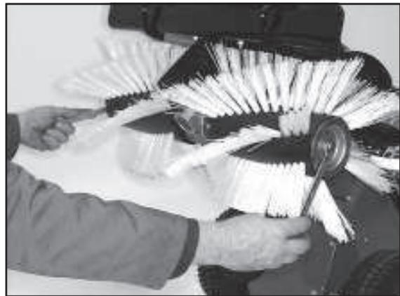
10) Muttern mit einem Ring-Maulschlüssel fest anziehen. Dabei mit einem weiteren Ring-Maulschlüssel kontern.
