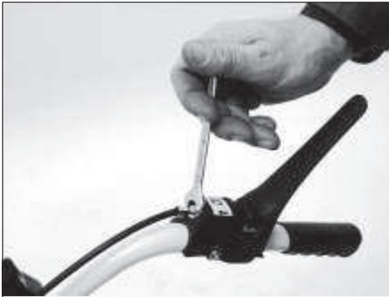
1) Die rechte Mutter mit einem 10er-Maulschlüssel um ca. eine Umdrehung lösen.
