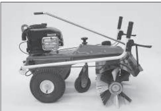
5) Zum Abstellen/Einlagern des Gerätes können Sie den Lenker ganz nach vorne klappen, um den Platzbedarf des Gerätes zu minimieren.
