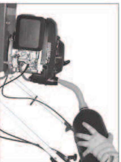
2) Halten Sie den Kanister wie auf dem Bild. Füllen Sie nur jeweils eine geringe Menge ein und kontrollieren Sie die Füllhöhe.
