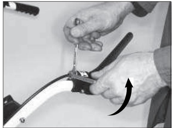
2) Anschließend die linke Schraube mit einem 8er Ring-Maulschlüssel um eine Umdrehung in Pfeilrichtung drehen. Danach die rechte Mutter kontern.
