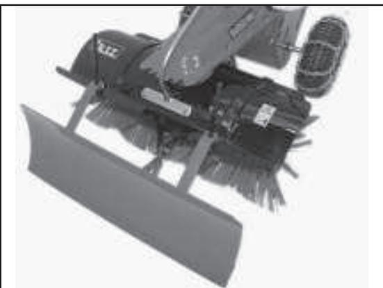
5) Korrekt montiertes Räumschild
