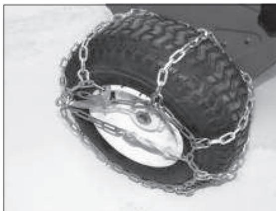
6) Die zweite Kette auf die gleiche Weise montieren.
