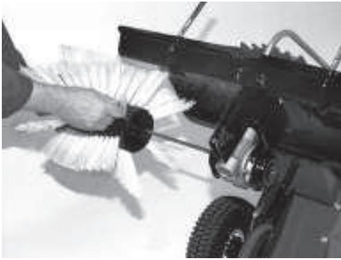
Bürste und Achse durch die entsprechende Öffnung schieben.
