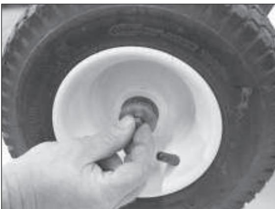
7) Schraube mit Scheibe montieren
