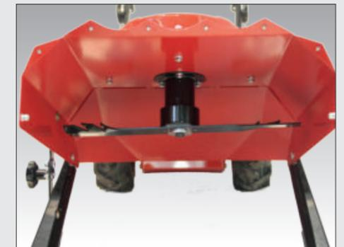
Das auf den Abtransport des Mähguts optimierte Mähdeck mit Wickelschutz für das **Mulchmesser**.
