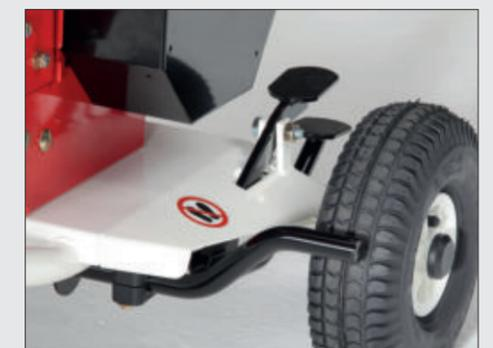
Die **Feststellbremse** sorgt für einen sicheren Stand während der Arbeit.
