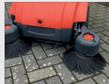
Mittels der **ausschwenkbaren Seitenbesen** lässt sich die Arbeitsbreite von 90 cm noch auf 110 cm erhöhen.
