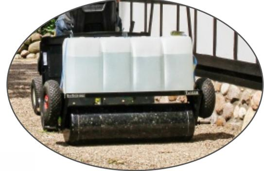
Die Walze dient zur mechanischen Verdichtung und sorgt für eine gleichmäßige und ebene Bodenoberfläche. Außerdem ist die Walze das ideale Werkzeug zum anwalzen von neu eingesättem Saatgut.
