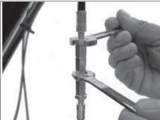
3) Lösen Sie die obere Mutter mit einem 10er und 8er Maulschlüssel. ACHTUNG! Linksgewinde
