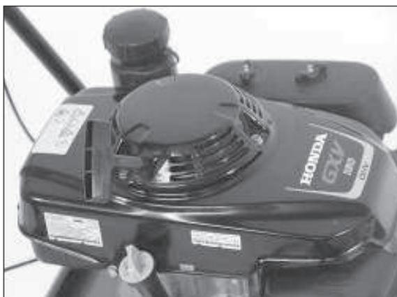
1) Kraftstoff- und Öltank beim Honda-Motor GXV160
