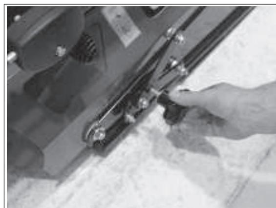
2) Sterngriff einige Millimeter in die Mähwerksstütze eindrehen.
