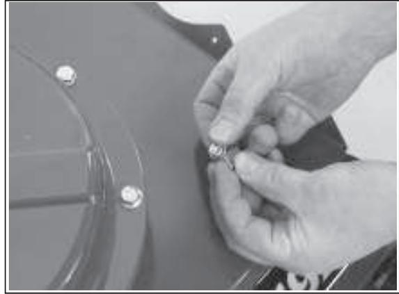
2) Schraube durch das Unterteil des Druckknopfes stecken.
