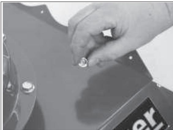
3) Schraube mit dem Unterteil des Druckknopfes durch die Bohrung stecken.
