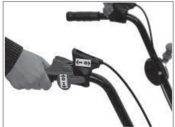
4) Durch Betätigen des Schalthebels schalten Sie den Mähantrieb ein.
