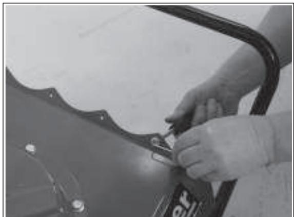
4) Schraube festdrehen. Bei den anderen Bohrungen ebenfalls die Unterteile der Druckknöpfe anbringen
