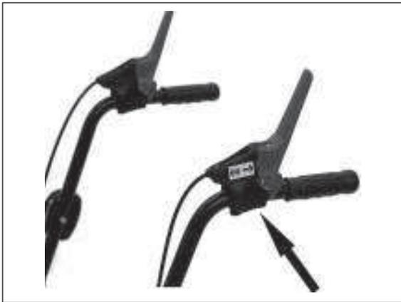
1) Am Lenker befindet sich der Schalthebel für den Radantrieb.
