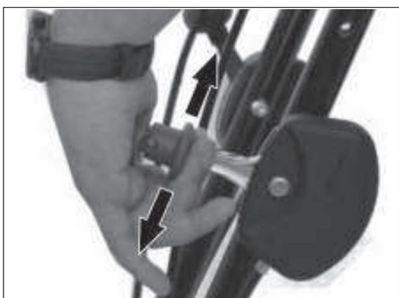
4) Der entspernte Schalthebel kann nun in die gewünschte Stellung gebracht werden.
