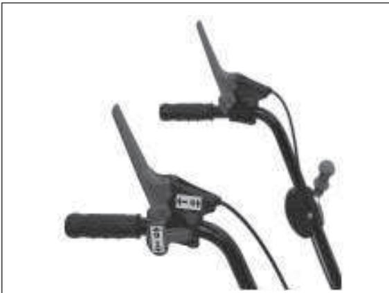
1) Am Lenker befindet sich der Schalthebel für den Mähantrieb.
