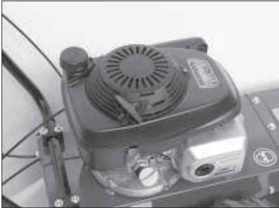
1) Kraftstoff- und Öltank beim Honda-Motor GXV160
