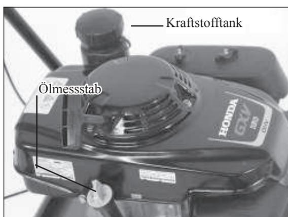
1) Kraftstoff- und Öltank beim Honda-Motor GXV160
