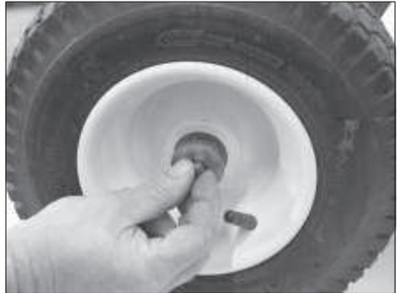
8) Schraube mit Scheibe montieren.
