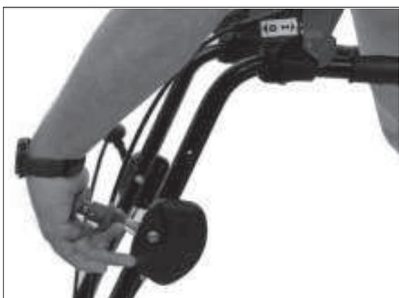
2) Der Schalthebel für die Dreigangschaltung ist wie in der Abbildung zu greifen.
