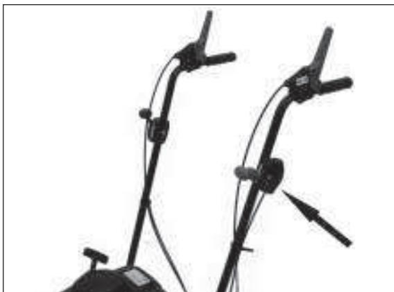
1) Am Lenker befindet sich der Schalthebel für die Gänge 1 bis 3.
