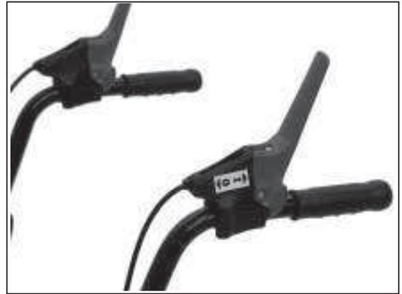
2) Der Schalthebel befindet sich in der Ausgangslage.
