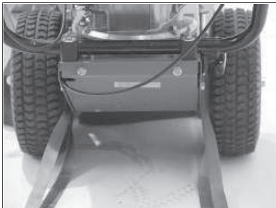
3) Verwenden Sie auf jeden Fall beide Befestigungspunkte.
