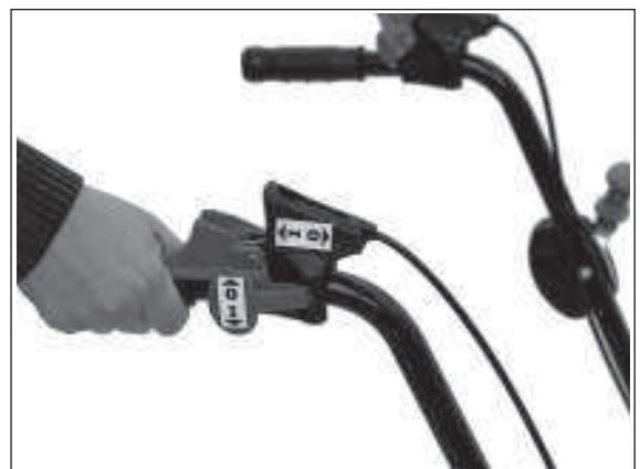
4) Durch Betätigen des Schalthebels schalten Sie den Bürstenantrieb ein.
