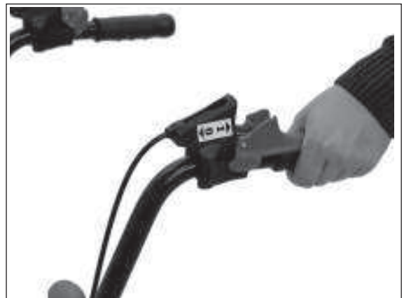
4) Durch Betätigen des Schalthebels schalten Sie den Radantrieb ein.
