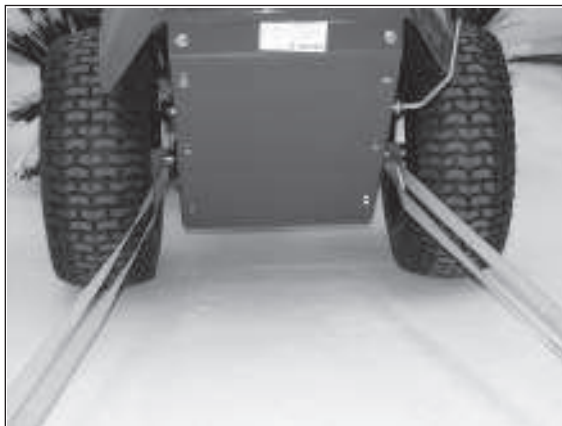
3) Verwenden Sie auf jeden Fall beide Befestigungspunkte.
