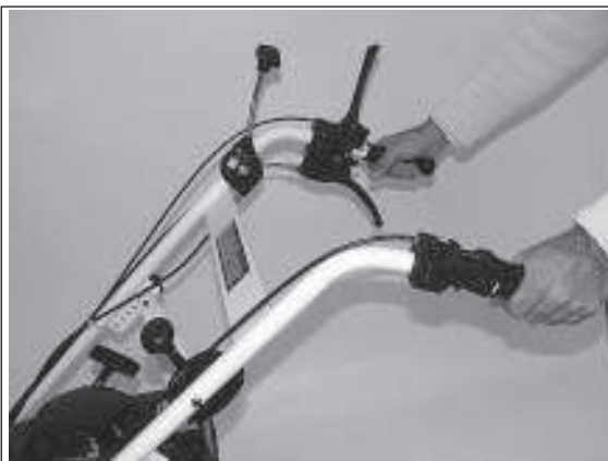
3) Mit der linken Hand wird die Kkehrbürste eingeschaltet.
