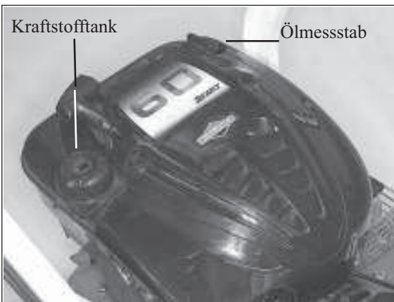
1) Kraftstoff- und Öltank beim B&S-Motor
