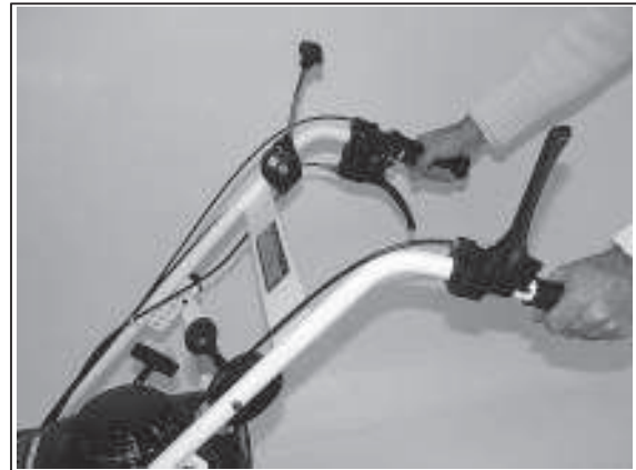
2) Durch Betätigen des rechten oberen Hebels schalten Sie den Fahrtrieb (vorwärts) ein.
