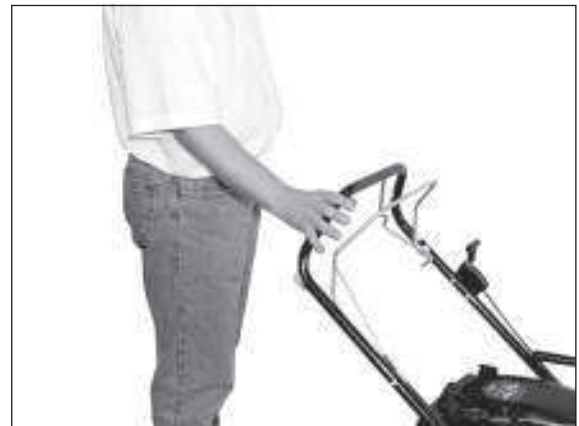
2) Durch Betätigen der Fahrtriebs-Kupplung setzen Sie die Kehrmaschine in Bewegung.
