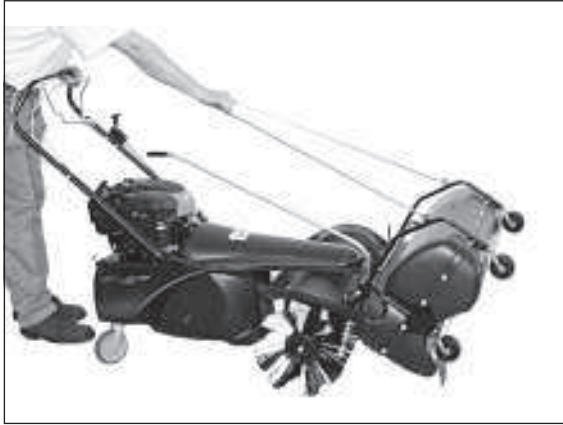
6) Um den Kehrgutbehälter zu entleeren, einfach vom Bedienerplatz aus am Zugbügel ziehen.
