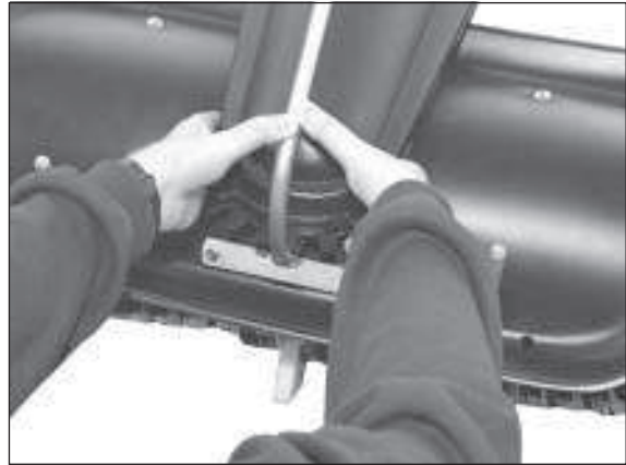
2) Haltepunkte vorne für das Anheben der Maschine.
