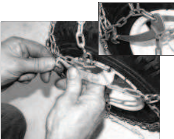
5) Den Spanner durch das freie Glied führen und einhaken. Der Spanner muss danach leicht unter Spannung stehen.
