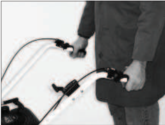
3) Durch Betätigen beider Schalthebel werden sowohl Kkehrbürsten- als auch Fahrtrieb eingeschaltet.
