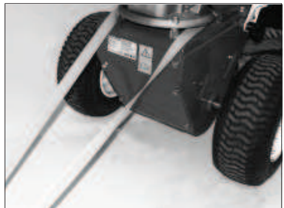
4) Der Motor dient als Befestigungspunkt. Verwenden Sie auf jeden Fall beide Befestigungspunkte. Der Lenker wird ganz nach vorne geklappt.
