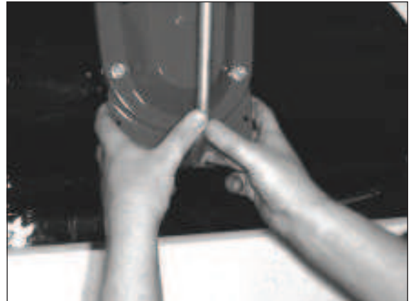
2) Haltepunkte vorne für das Anheben der Maschine.
