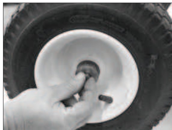
8) Schraube mit Scheibe montieren
